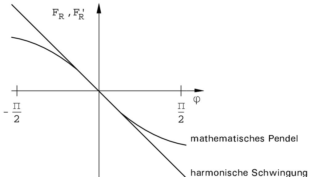
Abb. 1 : Abhängigkeit der rücktreibenden Kräfte vom Auslenkwinkel  $\varphi$
