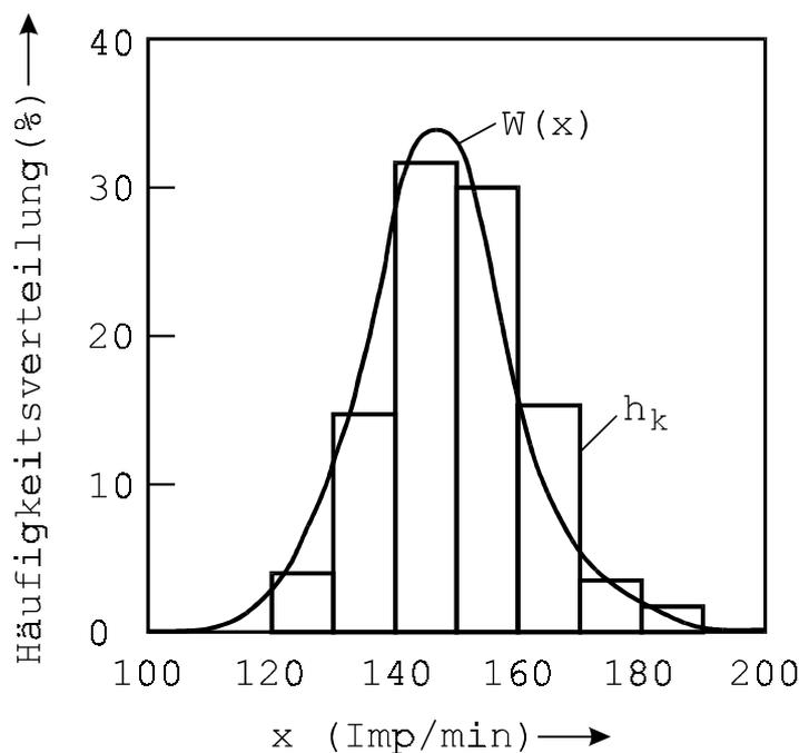
Abb. 2: Häufigkeitsverteilung einer Messreihe, eingezeichnet ist die Häufigkeit der Messwerte  $h_k$  im Intervall  $\Delta x = 10 \text{ Imp/min}$  (Säulendiagramm) und die Wahrscheinlichkeitsdichte  $w(x)$  nach Gl. (5)
